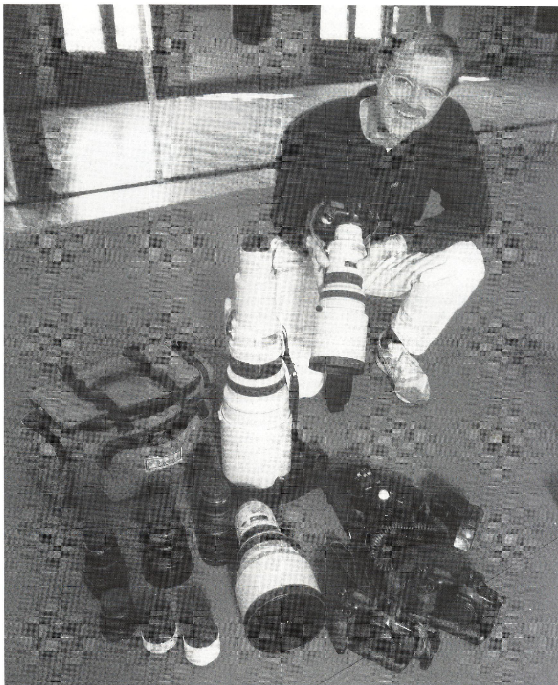
Per Kjærbyes reportageudstyr: Tre stk Canon EOS-1 med motor. Objektiverne er 600/4, 300/2,8, 200/1,8, 85/1,2, 80-200/2,8, 20-35/2,8, 15/2,8 samt 1,4x og 2x konvertere til de lange teler. Herudover 430EZ flash og Minolta lysmåler.
